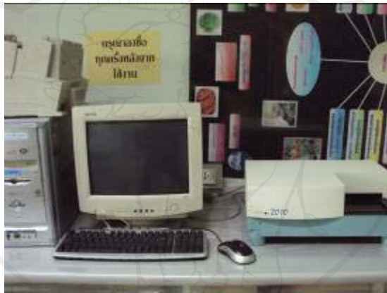
ภาพ จ.32 เครื่องแปลผลอะฟลาทอกซิน เอ็ม 1 ค่าที่ได้ Part Per Thrillion (พีพีที)
