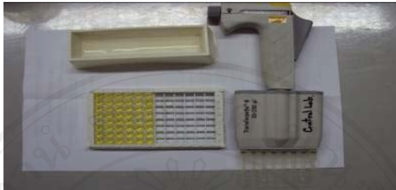
ภาพ จ.20 เติม Enzyme conjugate 50µl/หลุม ปฏิกริยาจะเกิดสีเหลือง
