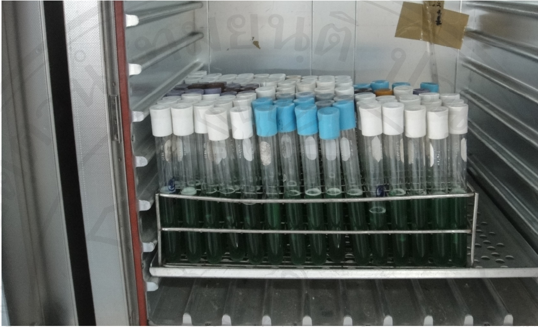
ภาพประกอบที่ 10 หลอดอาหาร 5% BGBB ที่เติมตัวอย่างอาหาร บ่มในตู้ Incubator
