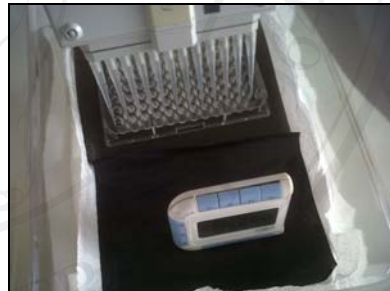
ภาพที่ 4 เติมสารละลาย 4-aminophenol hydrochloride ใน acetate buffer โดยใช้ multichannel
