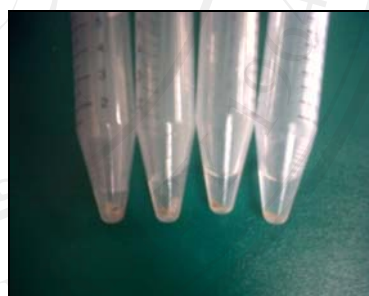
ภาพที่ 4 นำเกลือที่ละลายมา centrifuge เพื่อให้เศษดินตกตะกอนที่ก้นหลอด
