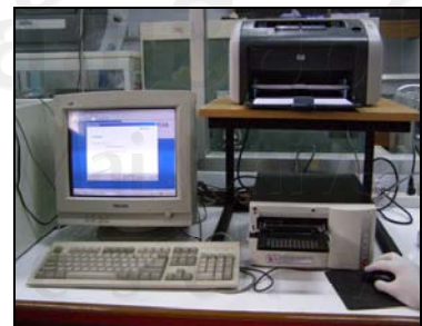
ภาพที่ 6 อ่านค่า standard curve ทำให้แล้ว คำนวณค่าไอโอดีนในหน่วย ppm
