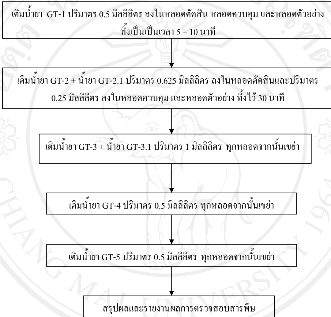
รูปภาพ 4.18 กระบวนการตรวจสอบสารพิษตกค้าง – ยาฆ่าแมลง จีที (Pesticide Test Kit)
