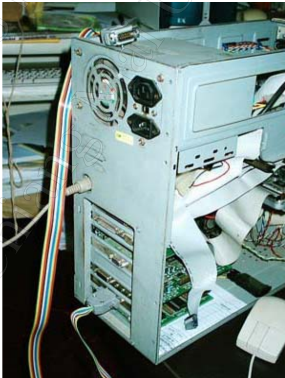
รูป ก.4 ลักษณะการเชื่อมต่อสายแพเข้ากับปลั๊กของการ์ด
