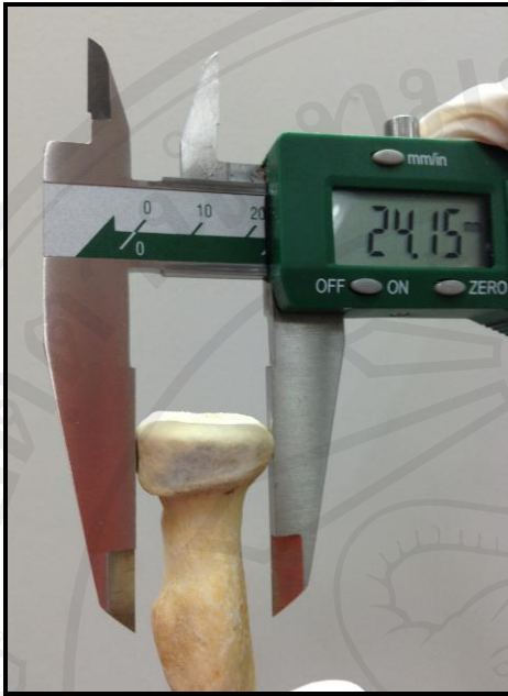
ภาพที่ 12 วิธีการวัดตัวแปร MaHD วัดค่าสูงสุดของเส้นผ่าศูนย์กลางของหัว radius โดยการหมุน caliper รอบหัวกระดูกเพื่อหาจุดที่ทำให้ได้ขนาดเส้นผ่านศูนย์กลางที่มากที่สุด
