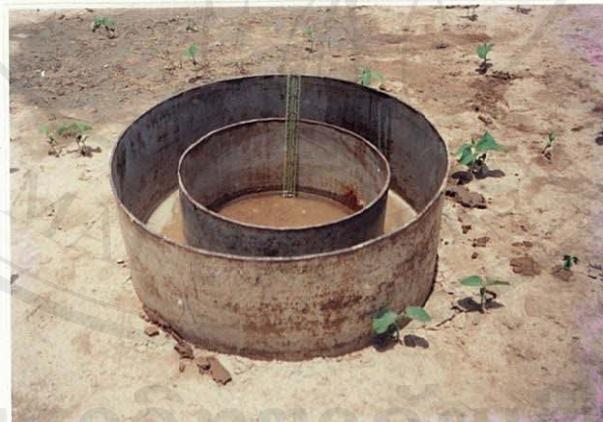
ภาพผนวกที่ 3 การวัดอัตราการซึมน้ำผ่านผิวดินแบบ double ring โดยใช้วิธีการลดลงของระดับน้ำเหนือผิวดิน
