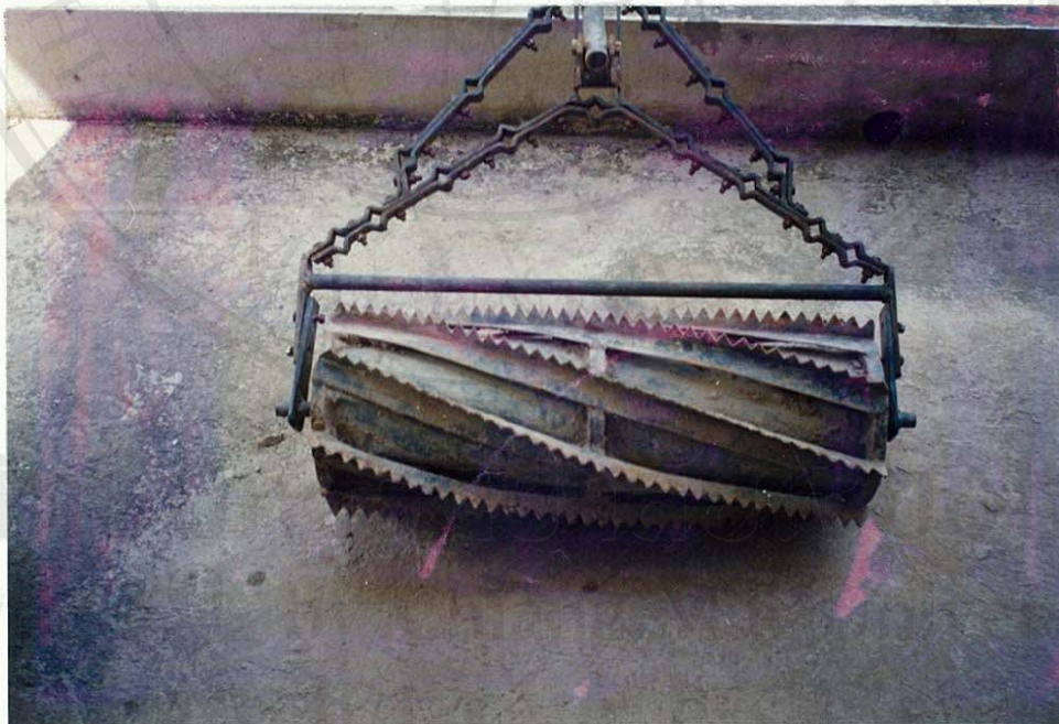
ภาพที่ 3 เครื่องทำลายแผ่นคราบแข็งแบบลูกกลิ้งฟันเลื่อย
