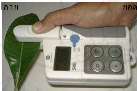
ภาพที่ 8 การวัดกิจกรรมของคลอโรฟิลล์ในใบด้วยเครื่อง Chlorophyll Meter (Konica Minolta, SPAD-502 Plus)
