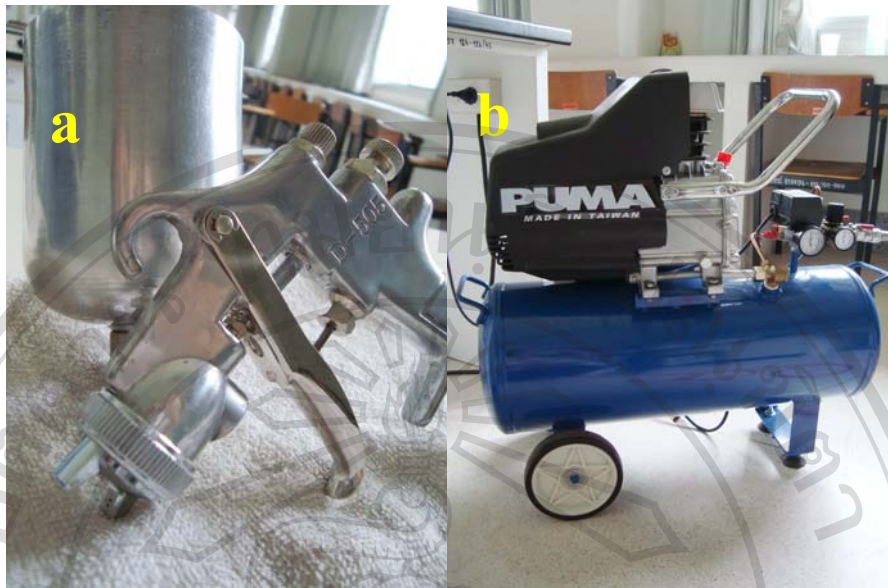
ภาพ ก.3 a) ชุดหัวฉีดของพอย b) และปั๊มลมแรงดันสูง
