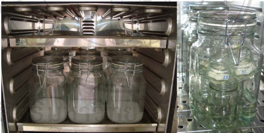
ภาพ ก.12 โหนดแก้วการศึกษา adsorption isotherm ของข้าวเคลือบสารสกัดจากใบเตย ที่บรรจุสารละลายเกลืออิมตัวในตู้ควบคุมอุณหภูมิ
