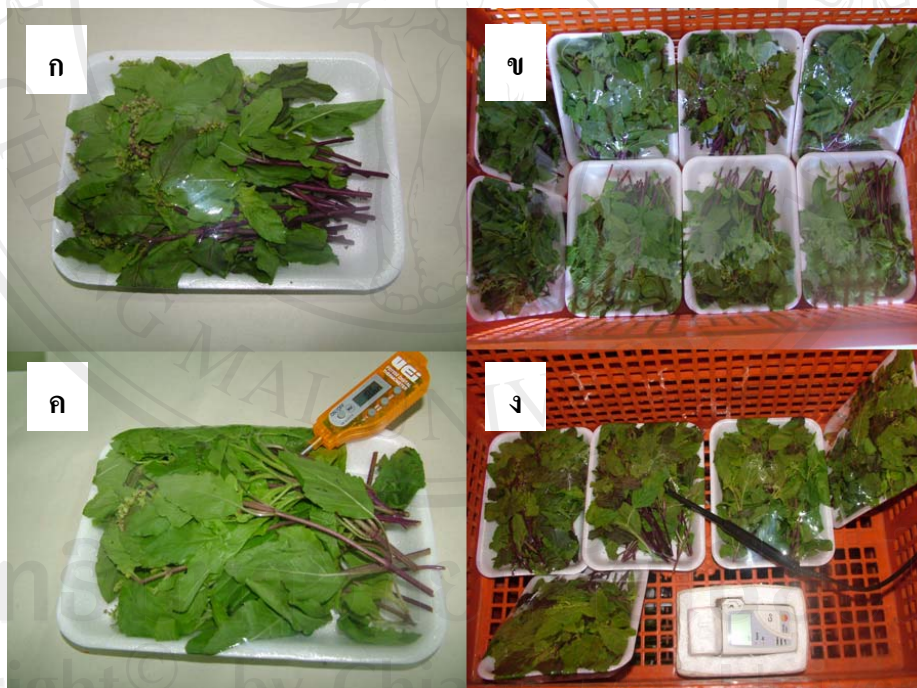
ภาพที่ 18 กะเพราแดงที่บรรจุอยู่ในถาดโฟมหุ้มด้วยพลาสติกฟิล์มโพลีไวนิลคลอไรด์ (ก) การจัดเรียงในตะกร้าพลาสติก (ข) การวัดอุณหภูมิเริ่มต้น (ค) การวัดอุณหภูมิใจกลางผักและความชื้นสัมพัทธ์ในระหว่างกระบวนการลดอุณหภูมิด้วยระบบสุญญากาศ (ง)
