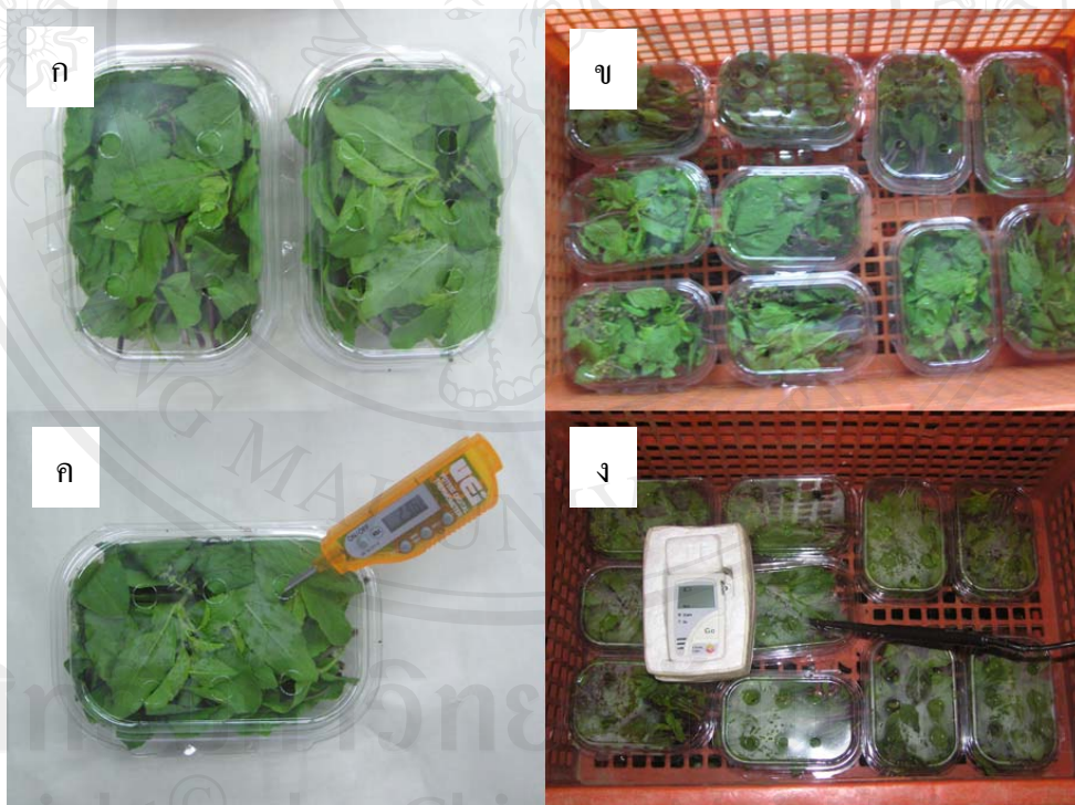
ภาพที่ 23 กะเพราแดงที่บรรจุอยู่ในกล่องพลาสติกโพลีเอทิลีนเทอร์พทาเลต (ก) การจัดเรียงในตะกร้าพลาสติก (ข) การวัดอุณหภูมิเริ่มต้น (ค) การวัดอุณหภูมิจากกลางผักและความชื้นสัมพัทธ์ในระหว่างกระบวนการลดอุณหภูมิด้วยระบบสุญญากาศ (ง)
