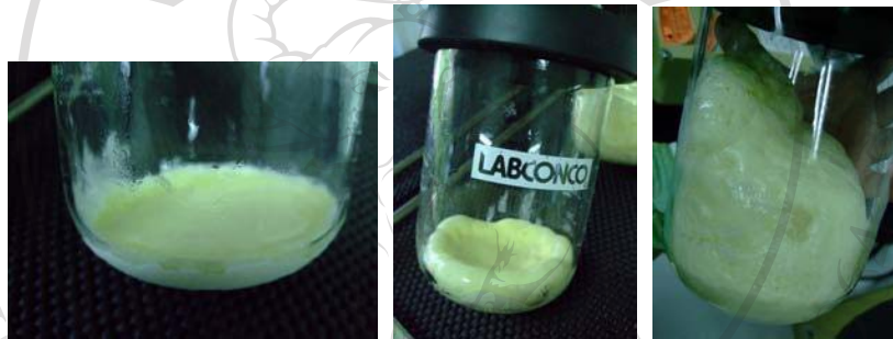
รูปที่ ค-11 ลักษณะของนมผงปรุงแต่งกลิ่นรส เริ่มต้นการทำแห้งแบบแช่เยือกแข็ง (ก) ทำแห้งผ่านไป 5 นาที (ข) ผ่านไป 24 ชั่วโมง (ค)
