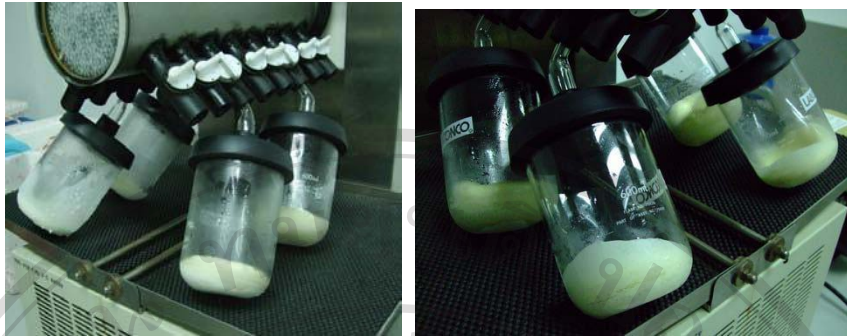
รูปที่ ค-10 การทำแห้งแบบแช่เยือกแข็งนมผงปรุงแต่งกลิ่นรส
