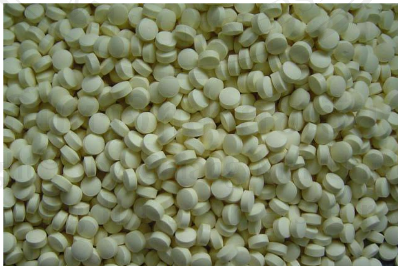
รูปที่ 4.17 : นมผงบริสุทธิ์อัดเม็ดที่ผลิตด้วยเครื่องอัดเม็ดแบบสากลเดี่ยว
