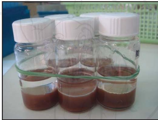
ภาพ ท.1 ขวดทดลองกระบวนการไบโอทรานส์ฟอร์มเมชันระบบของเหลวสองชั้นแบบแยกชั้นก่อนการทดลอง
