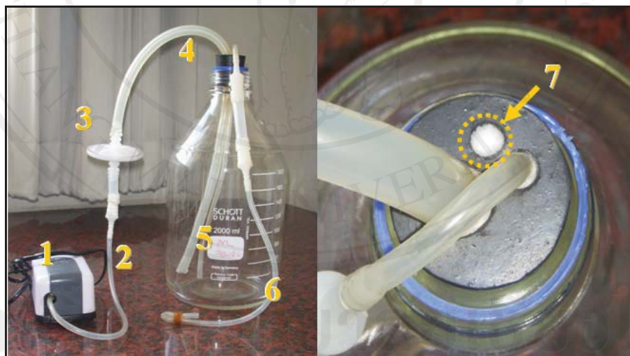
ภาพ 3.4 ชุดเพาะเลี้ยงจุลินทรีย์ระดับ 1,500 มิลลิลิตร มีส่วนประกอบดังนี้ 1) ปัมลม 2) ท่ออากาศเข้า 3) ชุดกรองอากาศ (air filtration unit) ทำจาก polyte-trafluoroethylene (PTFE) ขนาดรูพรุน 0.2 ไมโครเมตร 4) ท่ออากาศเข้า 5) ขวดเพาะเลี้ยงเชื้อขนาดใหญ่ 6) ท่อเก็บตัวอย่าง 7) ท่อก๊าซออก
