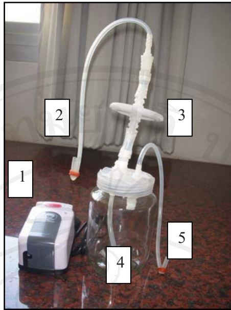
ภาพ 3.1 ชุดเพาะเลี้ยงจุลินทรีย์ระดับ 100 มิลลิลิตร ประกอบไปด้วย 1) ปั๊มลม 2) ท่ออากาศเข้า 3) ชุดกรองอากาศ (air filtration unit) ทำจาก polytetrafluoroethylene (PTFE) ขนาดรูพรุน 0.2 ไมโครเมตร 4) ขวดเพาะเลี้ยงเชื้อขนาดเล็ก 5) ท่อก๊าซออก
