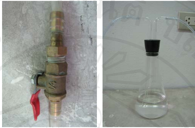
รูปที่ ก.6 ชุด ball valve เปิดปิดการไหลของอากาศและ saturation chamber
