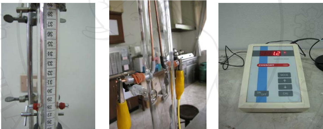
รูปที่ ก.4 แท่งหลอดทองแดงสำหรับวัดความนำไฟฟ้า และเครื่องวัดค่าความนำไฟฟ้า
