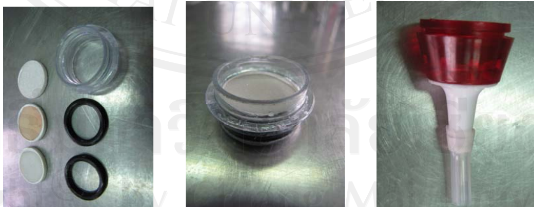
รูปที่ ก.5 แผ่น glass filter พร้อมชุดตัวยึดล็อกแผ่น
