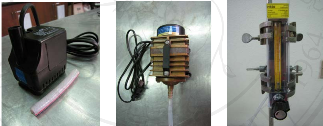
รูปที่ ก.7 ป้อนน้ำ ป้อนลม และ flow meter
