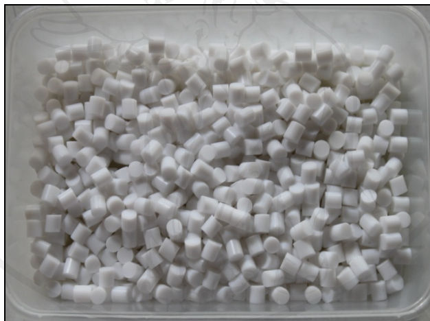
รูปภาคผนวก ฉ-2 เม็ดพลาสติกเทฟลอนที่ใช้เป็นอนุภาคเฉื่อย
