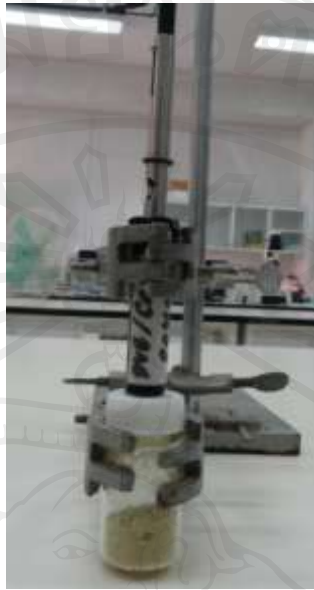
ภาพ ค-7 การสู่มไอตัวอย่างของผลิตภัณฑ์ไมโครแคปซูลน้ำมันหอมระเหยจากผักชีโร โดยวิธี SPME
