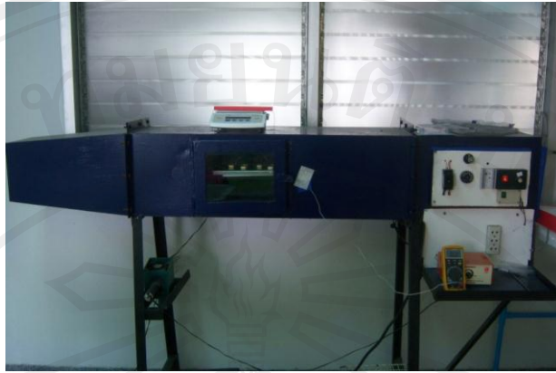
ภาพ ค-7 ลักษณะเครื่องทำแห้งลมร้อนแบบถาด
