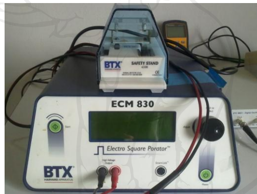
ภาพ ค-5 ลักษณะเครื่อง Electro Square Porator (BTX Harvard Apparatus รุ่น ECM 830)
