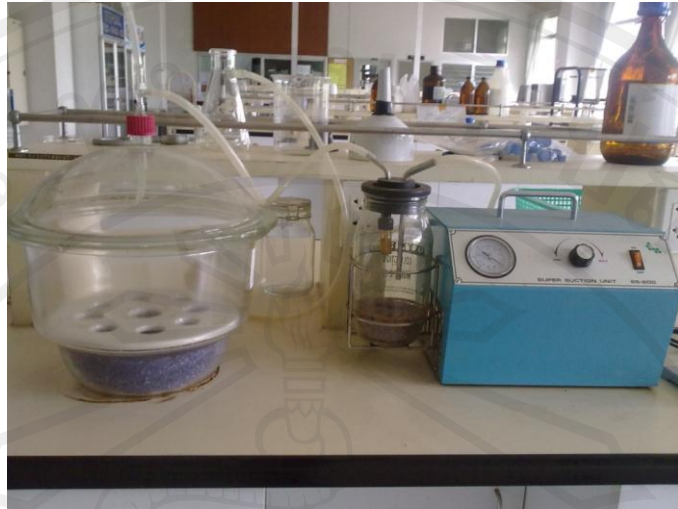
ภาพ ค-9 ลักษณะเครื่องปรับความดันสุญญากาศ
