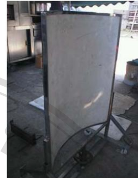
รูปที่ 8 ฉากกำบังรังสีแบบโค้งจากแบโรต์ผสมพอลิสไตรีนเรซินเคลือบด้วยไฟเบอร์กลาส
