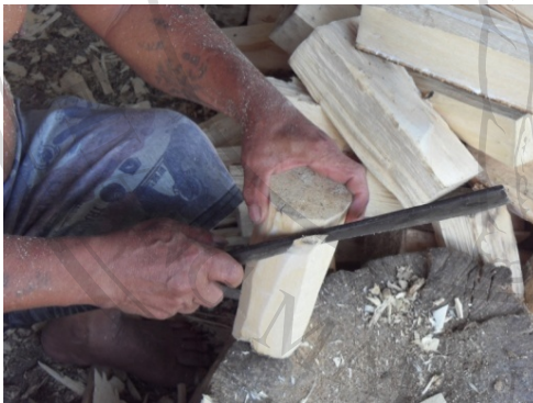
ภาพที่ 2 - 3 การถากไม้ให้เป็นรูปทรงกลม
