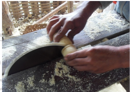
ภาพที่ 2 - 6 การตัดหัวร่มและตุ้มร่ม
