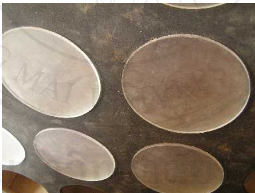
แผ่นอะคริลิกแบบขุ่นถูกทำมาปิดบริเวณแผงไฟ LED เพื่อสามารถควบคุมการกระจายแสงไฟ และทำให้มองเห็นสีของวงกลมชัดในขณะที่เล่น
