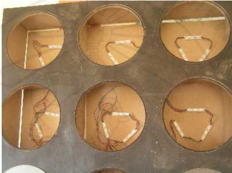
ภาพแผงวงจรไฟ LED ที่ถูกติดตั้งในกล่องไม้สำหรับสร้างระบบสุ่มไฟวงกลมสี
