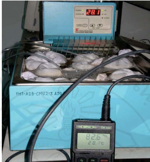
ภาพที่ 3.2 การแช่เมล็ดพันธุ์ข้าวญี่ปุ่นในน้ำอุณหภูมิ 28 องศาเซลเซียสที่มีการปล่อยออกซิเจนลงในน้ำเป็นระยะเวลา 24 ชั่วโมงจนถึงจุดอิ่มตัว
