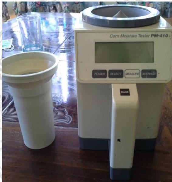
รูปที่ 4.8 เครื่องวัดความชื้นที่ผู้ประกอบการใช้วัดความชื้น
