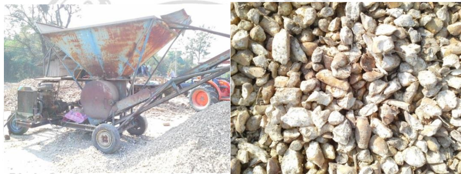
ภาพที่ 4.19 เครื่องสับหัวมัน (ซ้าย) และ มันเส้น (ขวา) ที่มา : จากการสำรวจ
