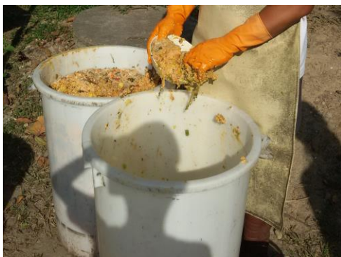
ภาพ 4.10 แสดงการเตรียมเศษอาหารเพื่อป้อนเข้าสู่ระบบผลิตก๊าซชีวภาพ
