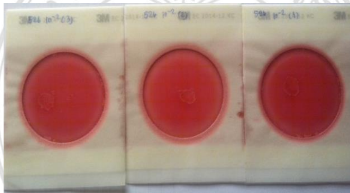
ภาพ ก-11 petifilm สำหรับตรวจเชื้อโคลิฟอร์มในเครื่องดื่ม
