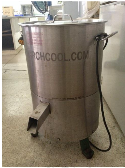
ภาพที่ ก-5 ลักษณะของเครื่องเหวี่ยงแยกน้ำแข็งทางด้านข้าง (ก) และด้านบน (ข)
