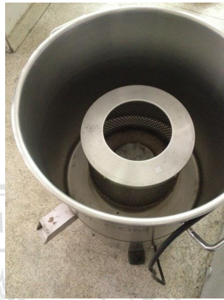
ภาพที่ ก-5 ลักษณะของเครื่องเหวี่ยงแยกน้ำแข็งทางด้านข้าง (ก) และด้านบน (ข)
