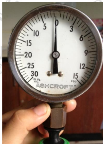
ภาพที่ ก-2 เครื่องวัดความดันก๊าซคาร์บอนไดออกไซด์
