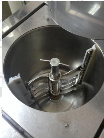
ภาพที่ ก-4 ลักษณะของเครื่องสร้างผลึกน้ำแข็งทางด้านหน้า (ก) และด้านบน (ข)
