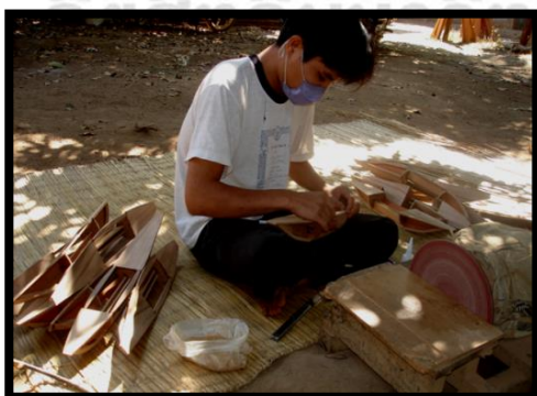
ภาพที่ 4.6 การนำชิ้นส่วนมาประกอบในตัวเรือ
