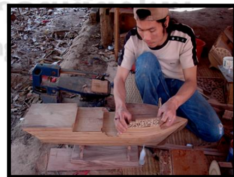
ภาพที่ 4.6 การนำชิ้นส่วนมาประกอบในตัวเรือ
