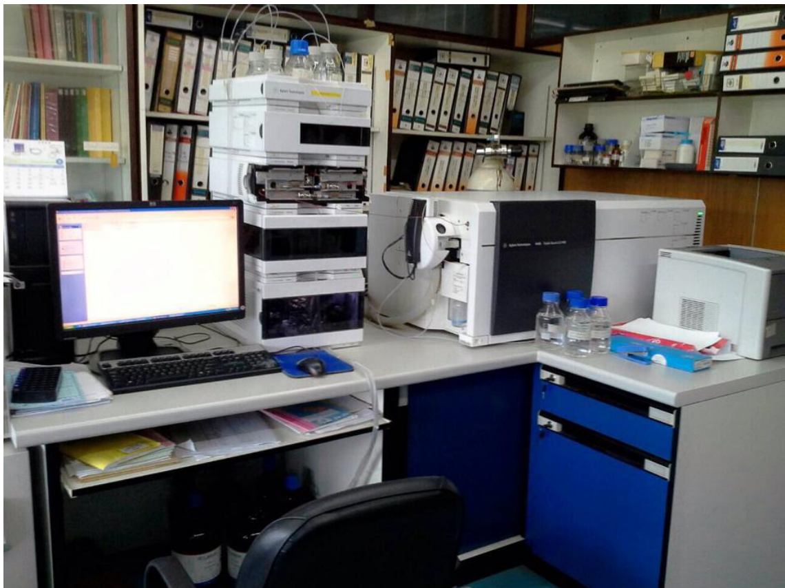
รูป 1 เครื่อง LC-MS (Agilent Technologies 1290 infinity LC ใช้คู่กับ 6460 Triple Quadrupole LC/MS, Column : Eclipse plus C18, 2.1mm.x100mm., Mobile phase A : 5mM Ammoniumformate หรือ 0.01% Formic in water, Mobile phase B : 0.01% Formic in Acetonitrile, Flow rate 0.3 mL/min, Injection 5 \mu L)
