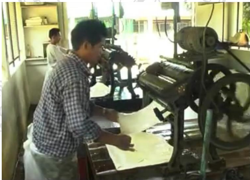
ภาพที่ 2.11 การรีดแผ่นยางพาราด้วยเครื่องรีดดอก
