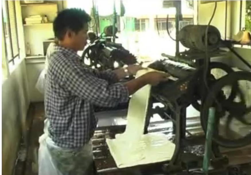
ภาพที่ 2.10 การรีดแผ่นยางพาราด้วยเครื่องรีดเรียบ
