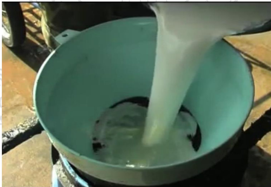
ภาพที่ 2.4 การกรองน้ำยางพารา จะทำการกรองน้ำยางพาราด้วยเครื่องกรอง
