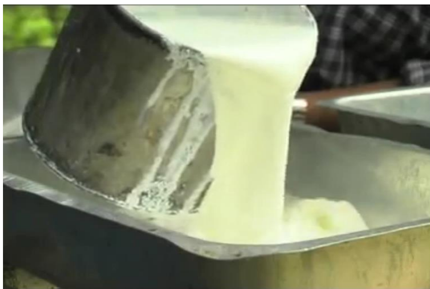
ภาพที่ 2.5 การตวงน้ำยางพาราใส่กระบะ หรือตะกุง คือบ่อซีเมนต์ใส่น้ำยางพารา
