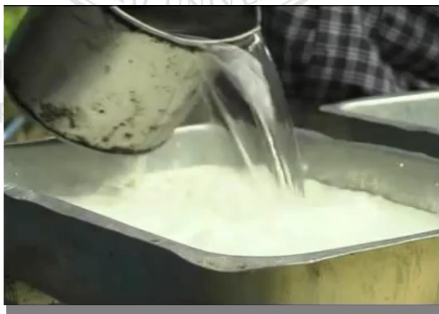
ภาพที่ 2.6 การผสมน้ำกับน้ำยางพารา
