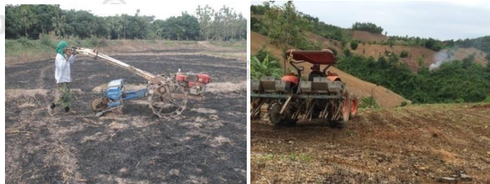
ภาพที่ 5.20 การปลูกข้าวโพดเลี้ยงสัตว์โดยใช้เครื่องหยอดเมล็ด
