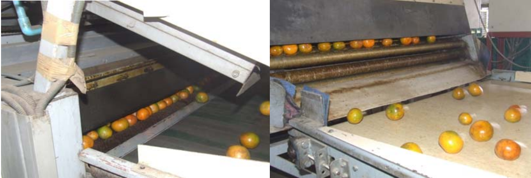
รูปที่ 5.6 ผลผลิตส้มผ่านแป้นแข็งด้วยลมร้อนและเข้าสู่รางเว้า
