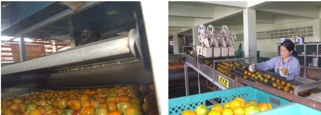
รูปที่ 5.7 ผลผลิตส้มผ่านการอบด้วยความร้อนและเข้าสู่รางติดสติ๊กเกอร์ตามแบรนด์
