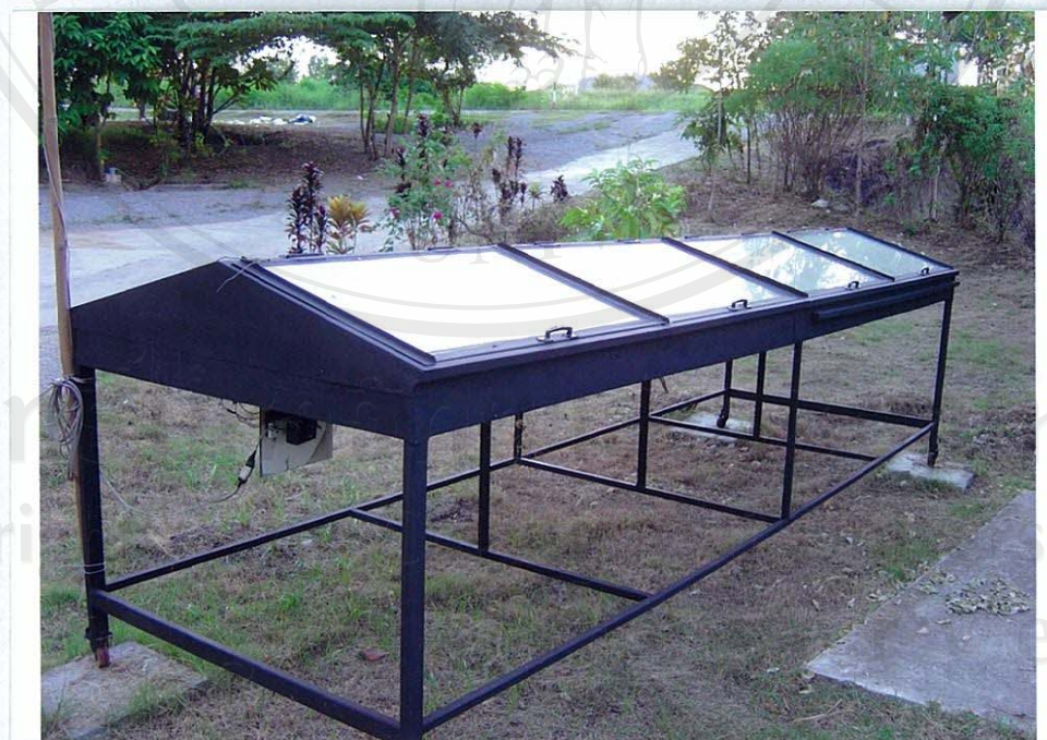
ภาพ ก 2 เครื่องอบแห้งพลังงานแสงอาทิตย์ (Solar tunnel dryer) (ด้านข้าง)
