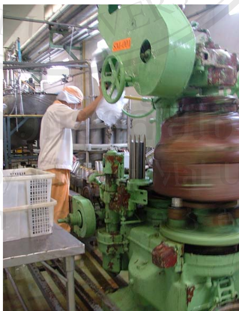
ภาพที่ 4.14 เครื่องปิดฝ้อกระจบองอัตโนมัติ
