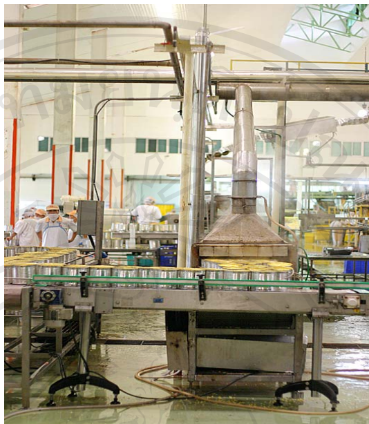
ภาพที่ 4.13 การไล่อากาศในข้าวโพดบรรจุกระจบอง โดยเครื่องไล่อากาศ
