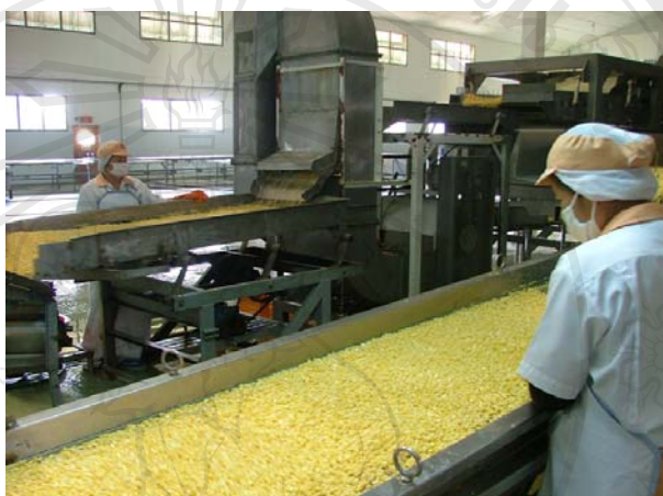
ภาพที่ 4.7 การร่อนเมล็ดข้าวโพดด้วยตะแกรงร่อนหยาบ
