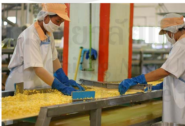
ภาพที่ 4.10 การคัดตำหนิครั้งสุดท้ายด้วยพนักงานก่อนการบรรจุกระป๋อง
