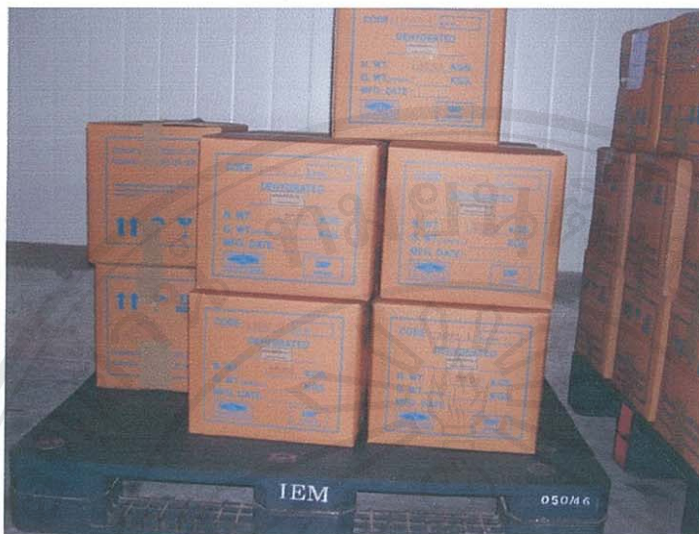
ภาพที่ 4.12 การเก็บรักษาผลิตภัณฑ์ที่สามารถป้องกันการปนเปื้อนโดยจัดวางบนพาเลทพลาสติกและป้องกันการเสื่อมสลายของผลิตภัณฑ์และภาชนะบรรจุโดยจัดเก็บในห้องเย็น
